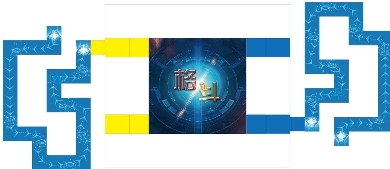
场地分为赛道区和格斗擂台区，高度都为6cm。赛道为30cm宽，单侧总长900cm。中间方形擂台区为2\*2m见方，两侧设置双方黄蓝出发区，平地尺寸为50\*40cm，出发区坡道水平长度为40cm，宽度为40cm，坡道顶端高度与擂台平齐，即6cm。赛道末端有下坡部分长度为30cm，宽度为30cm。场地材质为ABS。
